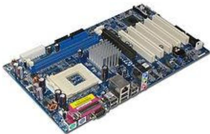
**La carte mère** : C'est le cœur de tout ordinateur. Elle est essentiellement composée de circuits imprimés et de ports de connexion, par le biais desquels elle assure la connexion de tous les composants et périphériques propres à un micro-ordinateur (disques durs, mémoire vive, microprocesseur, carte graphique, carte réseau, etc.) afin qu'ils puissent être reconnus et configurés par la carte mère lors du démarrage.
