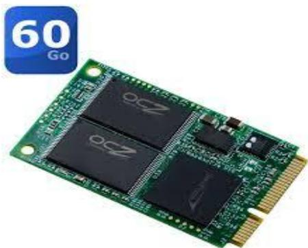
**Le disque SSD** : Un disque avec de la mémoire flash peut remplacer un disque dur. On parle dans ce cas d'un disque SSD (*Solid State Drive*). Son principal avantage est son temps d'accès
