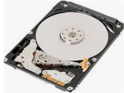
**Disque dur et disque dur hybride :** La plupart des disques durs et des disques durs hybrides tournent à une vitesse de 5400 tours minute et d'autres de qualité supérieure, tournent à une vitesse de 7200 tours minute. Si vous prévoyez enregistrer beaucoup de films, de vidéos, de photos et de diaporamas, un disque dur d'une capacité de **2 To = (2000 Go)** serait préférable.
